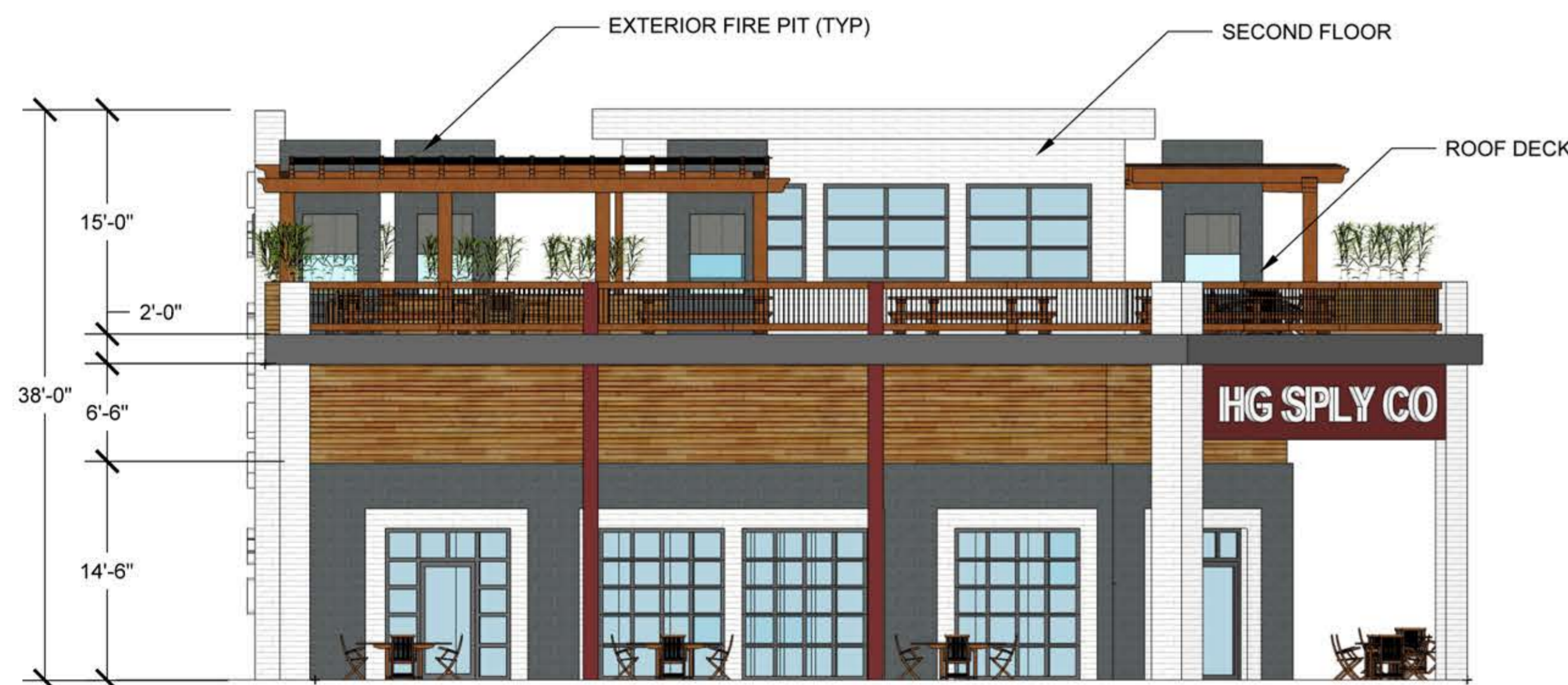
1 WEST ELEVATION - SUNSET RIDGE SCALE: 1/8" = 1'-0"
