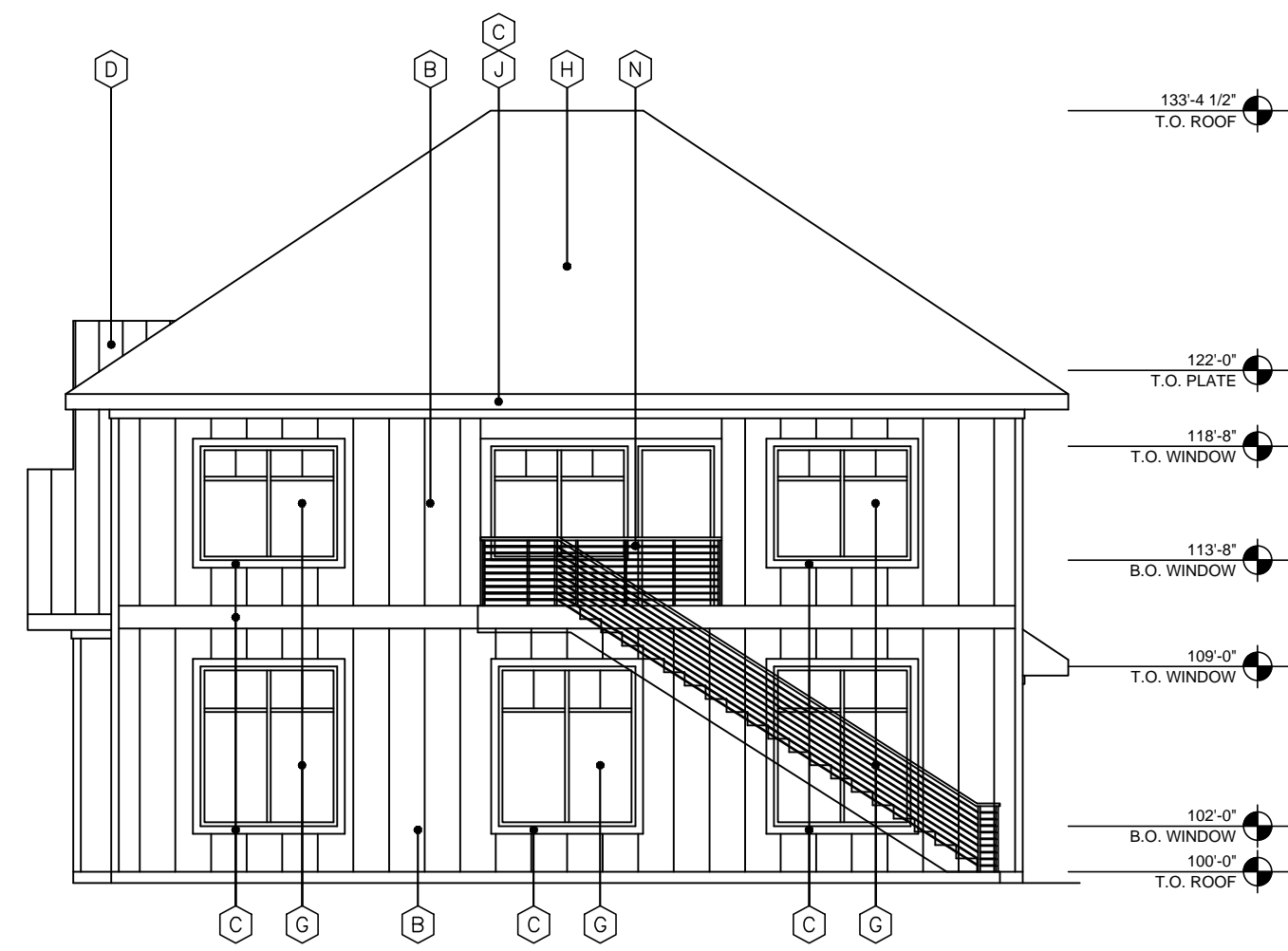
3 EAST ELEVATION SCALE: 1/8" = 1'-0"
