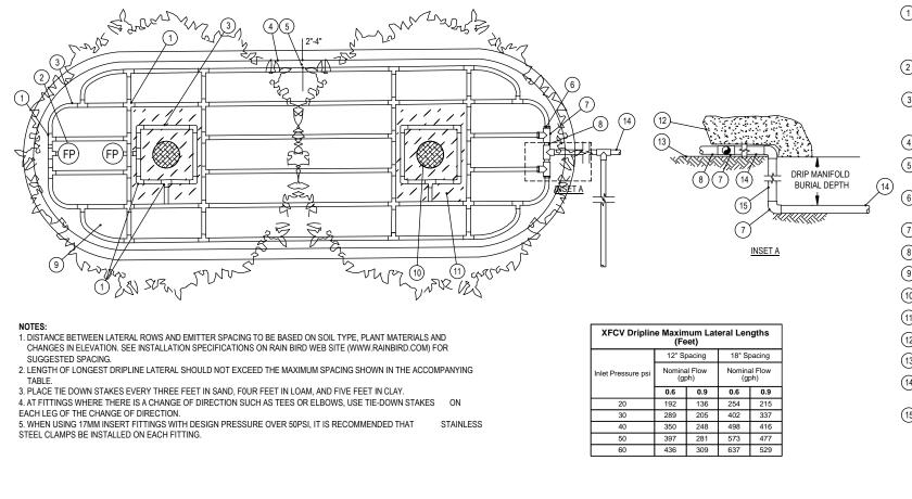
1) BARB X BARB INSERT EL, TEE OR CROSS: RAIN BIRD XFF-ELBOW (TYPICAL)
