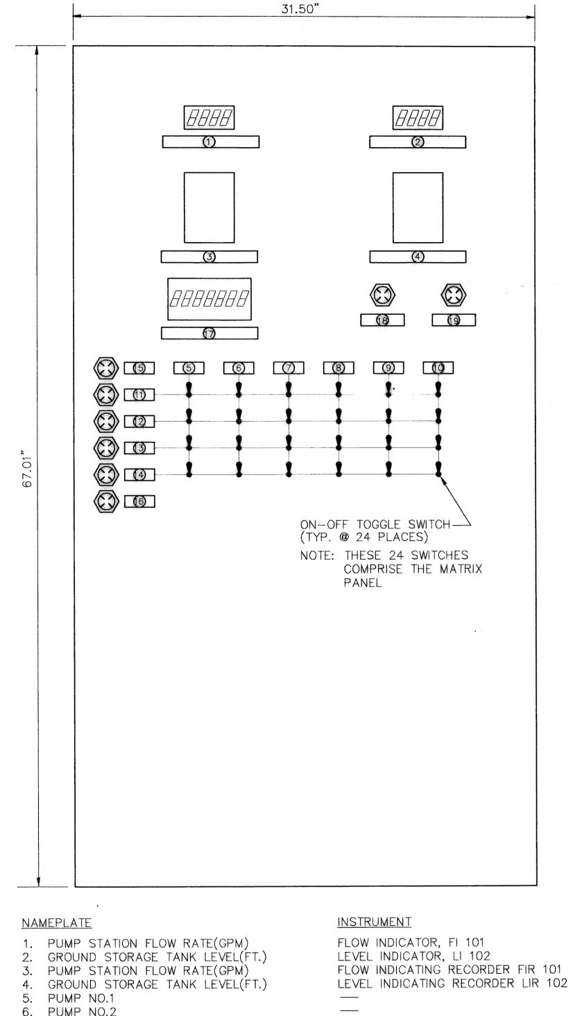
6. PUMP NO.2 7. PUMP NO.3 8. PUMP NO.4 9. PUMP NO.5 10. PUMP NO.6 11. STEP NO.1 12. STEP NO.2 13. STEP NO.3 14. STEP NO.4 15. ELEVATED TANK HIGH LEVEL 16. ELEVATED TANK LOW LEVEL 17. PUMP STATION FLOW(READING X 1000=GALS) INTEGRATOR FY 101 AND TOTALIZER FQI 101 18. GROUND STORAGE TANK LOW LEVEL 19. GROUND STORAGE TANK HIGH LEVEL AIL
